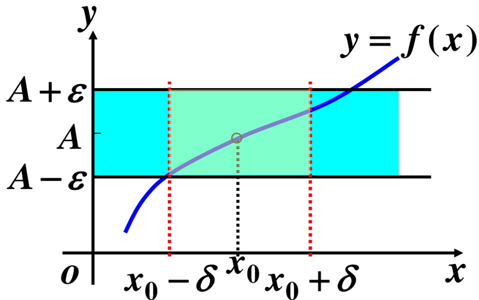
当  $x$  在  $x_0$  的去心  $\delta$  邻域时, 函数  $y = f(x)$  图形完全落在以直线  $y = A$  为中心线, 宽为  $2\varepsilon$  的带形区域内.
